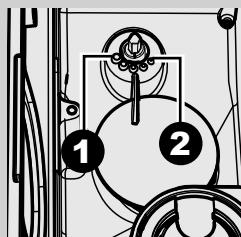
**3** Отметки, имеющиеся внутри емкости для кофе в зернах, указывают заданную степень помола. Можно выбрать 5 различных степеней помола, начиная с положения 1 (●) для крупного помола и более легкого вкуса, и заканчивая положением 2 (○) для мелкого помола и более насыщенного вкуса. Если кофе водянистый или медленно выходит, измените настройки кофемолки.
