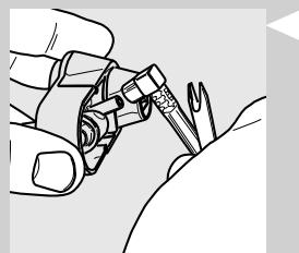
**18** Снимите всасывающую трубку.
