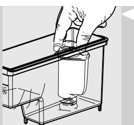
**4** Вставьте фильтр для воды «INTENZA +» в пустой бак для воды. Сдвиньте его как можно ниже.
