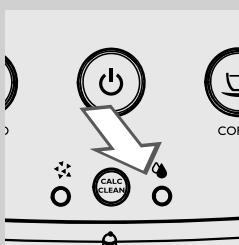
13 Светодиод «» выключается. Когда кнопка «» мигает, нажмите ее, чтобы включить цикл ополаскивания.
