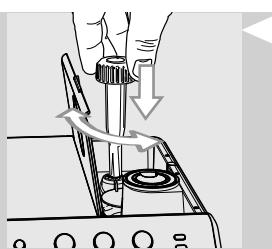
**2** Пока машина перемалывает, нажмите и поверните ручку для регулировки помола, расположенную внутри емкости для кофе в зернах, только на одно деление за раз. Используйте специальный ключ для регулировки кофемолки, поставляемый в комплекте. Разница вкуса будет ощутимой после подачи 2-3 кофе.
