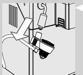
**15** Снимите автоматический вспениватель молока с трубки пара.
