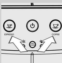
15 Машина выполняет автоматический подогрев и ополаскивание. Кнопка «» и кнопка «» будут мигать одновременно. Цикл очистки от накипи закончен.
