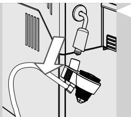
**1** Снимите автоматический вспениватель молока с трубки пара.
