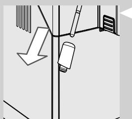
**16** Снимите хромированный кожух с резиновой накладкой с трубки пара.
