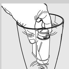
**2** Достаньте фильтр для воды «INTENZA+» из упаковки и погрузите его в вертикальном положении (отверстием вверх) в холодную воду, затем слегка нажмите на боковые стенки, чтобы вышли пузырьки воздуха.
